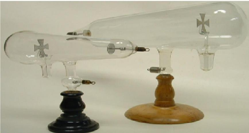
Tube de Crookes ou Tube à Décharge
